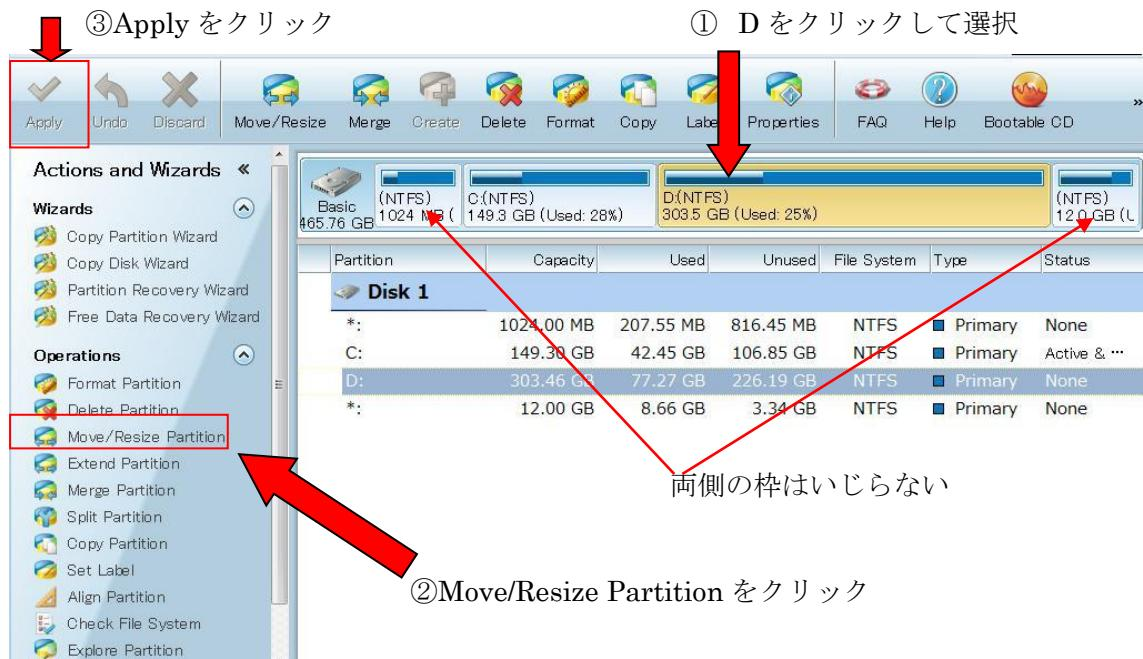
D ディスクの容量を減らすので①D をクリック。②Move/Resize をクリックすると、D ディスクの容量変更画面が出るので、右からドラッグして、D のサイズを変える。③Apply をクリックして、決定する。(以下画面表示は略) 続いて C ディスクをクリックして、容量を拡大するので Extend Partition をクリックして変更画面を出す。D ディスクの減らした分量だけを、右に拡大する。同じく③の Apply で決定。
