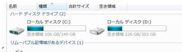
ハードディスクには C と D の 2 つのディスクがある。上図はパーティション変更後のもの。C ディスクが 50G のうち 42G の容量を使用していた。20%以上の空きがあるのが理想的。ソフト追加、アップデートなどで自然とデータは C ディスクにたまってしまう。そうすると様々なトラブルの原因になる。D ディスクの容量を減らして、C ディスクの容量を空けるのが、パーティション変更という作業だ。非常にむずかしい作業で、普通は製造会社にパソコンを送って、専門家にお願いする作業である。今回は、井坂さんが自宅に来て行っていただいた。以下に作業の流れを紹介するが、専門家の手助けで行った方がいい。専門家が行っても、データが消えてしまうことがあるので、データのバックアップは必ず行っておく。最初にインストールした OS 等の入った CD を確認しておく。
