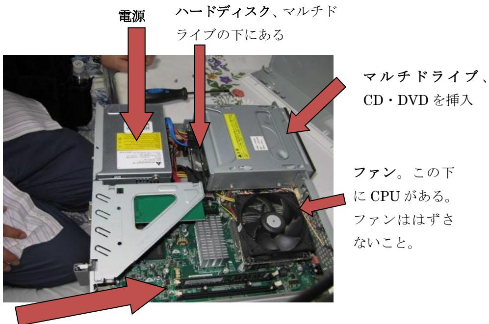
メモリ。2列になっている。下側が空いている。ご自分のメモリ容量を調べるには、「コントロールパネル」—「システムとメインテナنس」をクリックして開ける。メモリ容量の組み合わせに注意。総容量4Gの場合、すでに2Gのメモリが入っていれば、2Gのメモリを増設する。それ以上のメモリを入れても、パソコンは動作しない場合がある。
